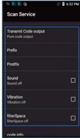
**Transmit Code output:** "Pure code output" - вывод только данных штрихкода, "Code Type output"- вывод данных штрихкода и типа кода.
