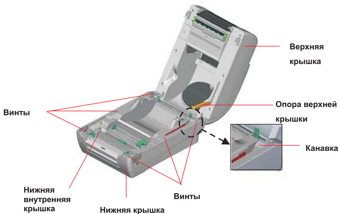
Рис. 13. Отверните 6 винтов нижней внутренней крышки
