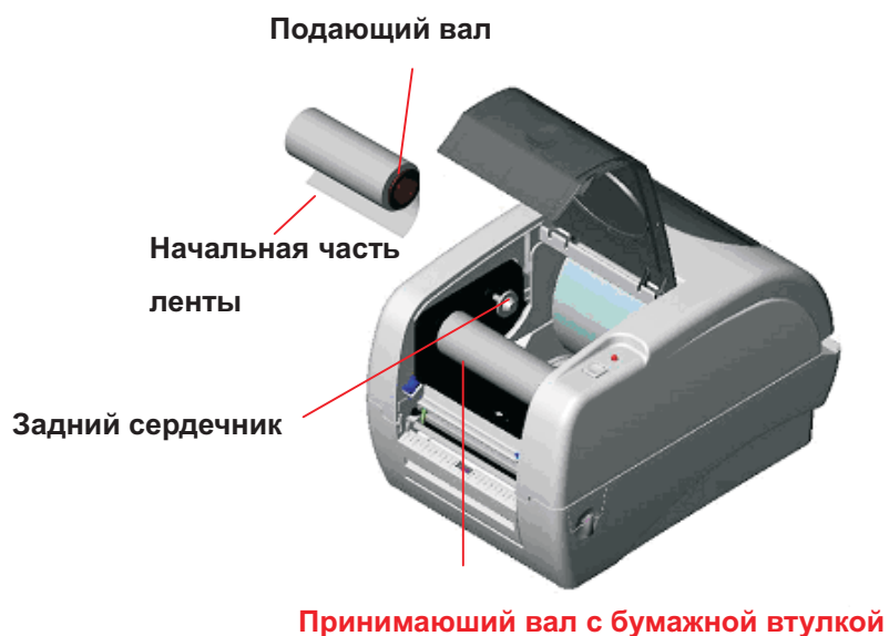
Рис. 5 Установка ленты (II)
