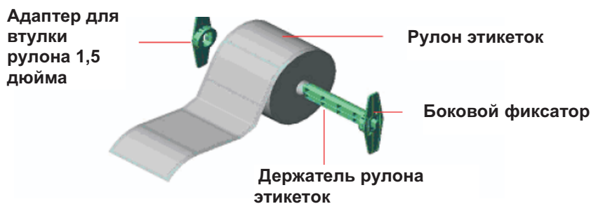
Рисунок 6. Установка рулона этикеток (I)
