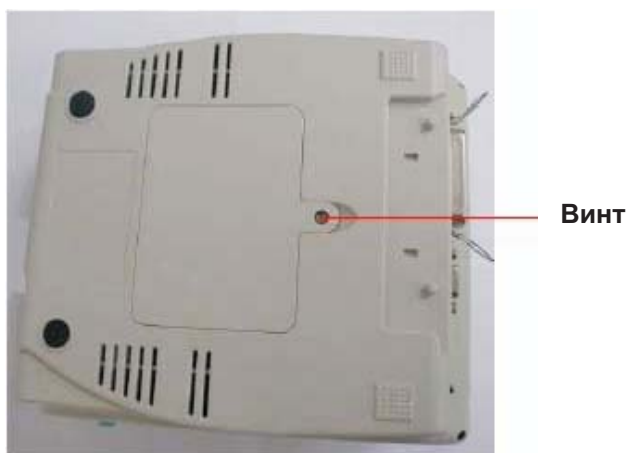
Рисунок 21. Открутите 1 винт с нижней части принтера
