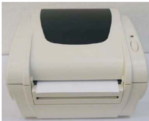
Рисунок 19. Плотно закройте верхнюю крышку
