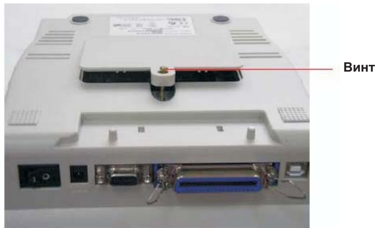
Рисунок 10. Открутите один винт из крышки платы памяти в нижней части принтера
