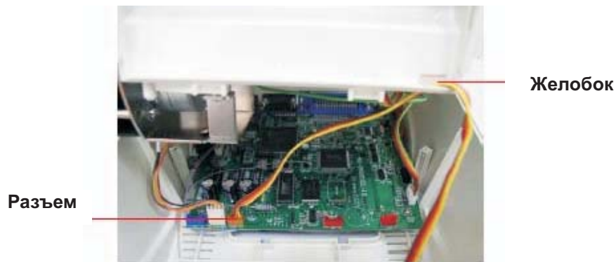
Рисунок 22. Размещение кабеля от ножа
